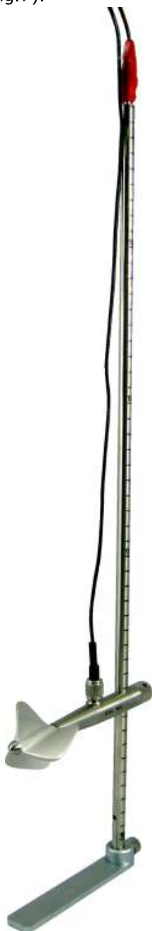
fig. 7: Mini molinete M1 sobre barra 9 mm dia.
