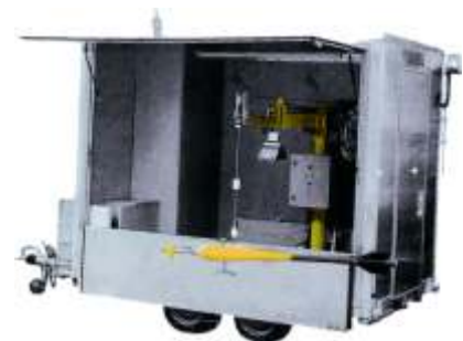
Remolque de medida con torno SEW-II mecánico o eléctrico para la medición del caudal desde puentes
